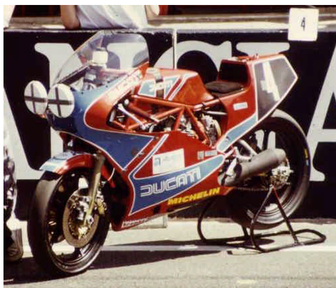
Beide Aufnahmen stammen vom 24-Stunden-Rennen 1984 in Le Mans. Hier ist die Werks-TT1 mit der normalen Cantilever-Federung am Hinterrad zu sehen, baugleich der TT2
