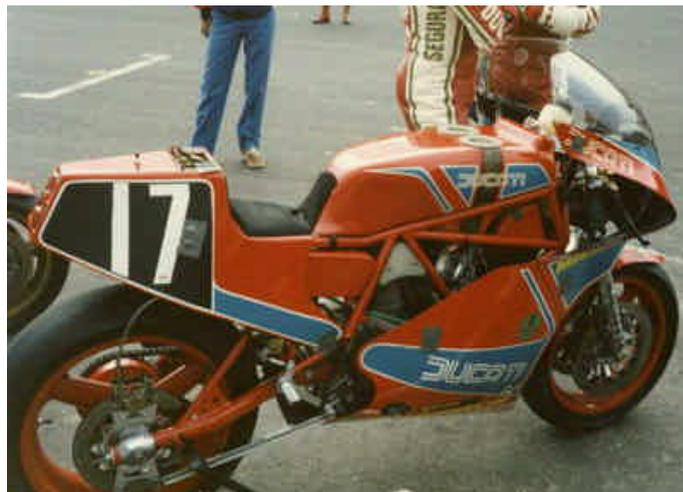
*Die Werks-Langstreckenmaschine beim 8-Stunden-Rennen am Nürburgring 1984 in der einfachen Cantilever-Ausführung mit Stahlschwinge.*
